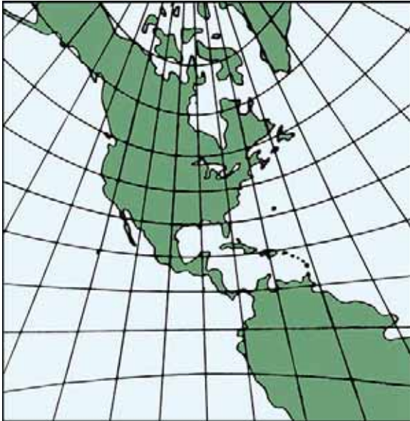
Figure 416b. An oblique gnomonic map with point of tangency at latitude 30°N, longitude 90°W.
